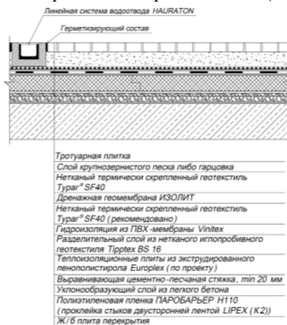
Рисунок 20. Узел (Устройство эксплуатируемой кровли (иллюстрация автора))
